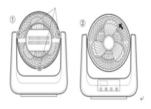
3. 扇葉拆洗: 以順時針方向旋轉扇葉束,即可拆下扇葉清洗。
